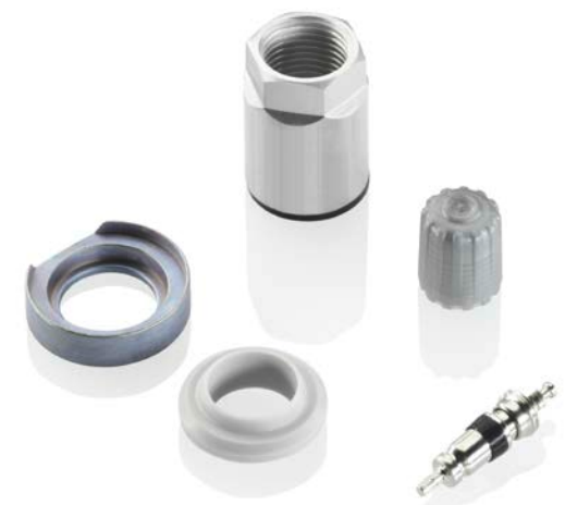
RDK-System Service-Kit besteht aus: Ventileinsatz, Befestigungsmutter, Dichtung, Dichtscheibe und Ventilkappe.
